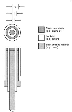
**Figure 9.4.1** Ring-disk electrode.
